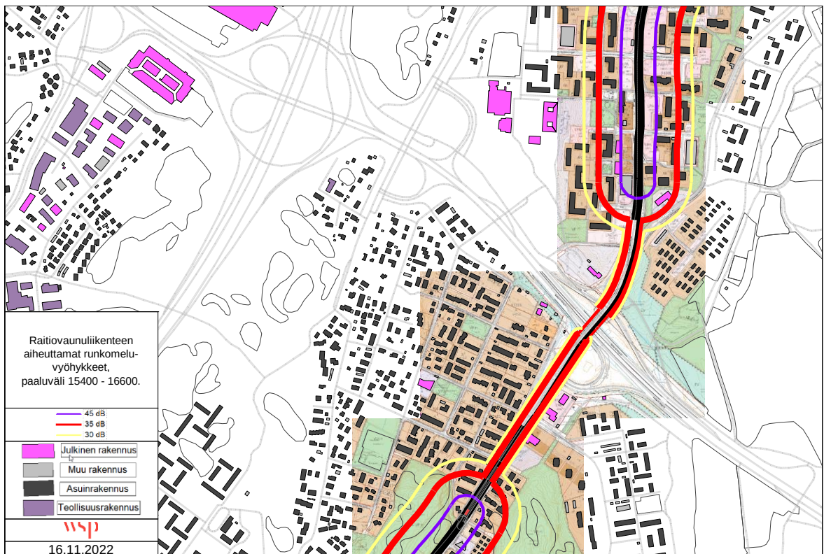
Kuva 8. Raitiovaunuliikenteen aiheuttamat runkomelualueet Hakunilan eteläosassa ja Vaaralan pohjoisosissa, paaluväli 15400 - 16600.
