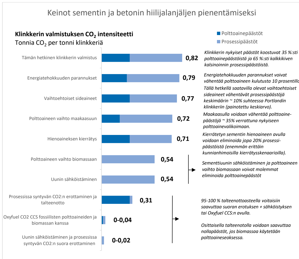
Kuva 7. Keinot sementin ja betonin hiilijalanjäljen pienentämiseksi. (Käännetty ja muokatta: Material Economics, 2019)
