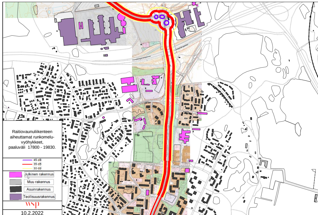
Kuva 10. Raitiovaunuliikenteen aiheuttamat runkomelualueet Fazerintien ja Länsimäentien varrella, paaluväli 17800 – 19830.
