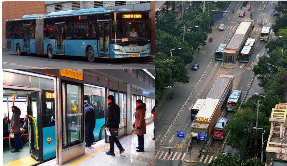
Kuva 11. Lanzhoussa on käytössä nivelbussi, jossa ovet ovat kaluston molemmilla puolilla laiturien tehokkaan kaksipuoleisen käytön mahdollistamiseksi. Lähde 1 , Lähde 2 , Lähde 3 .
