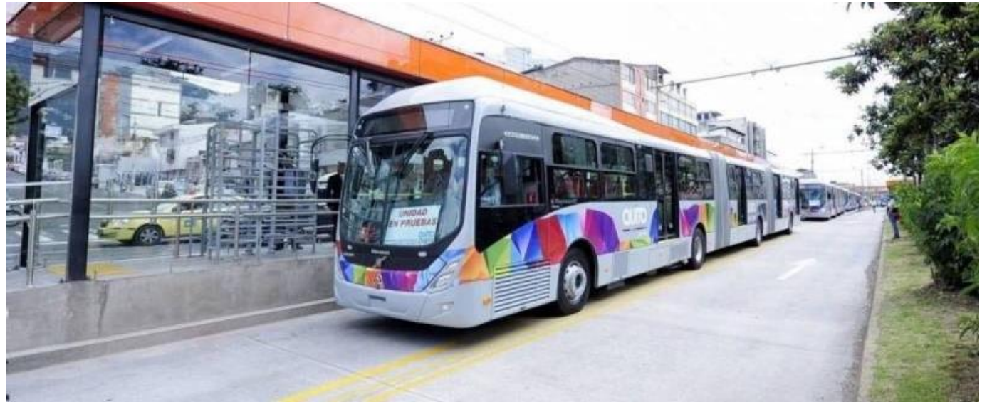
Kuva 10. Quitossa käytössä oleva kaksoisnivelinen ja korkealattianen bussi, jossa on ovia molemmilla puolilla. Lähde .
