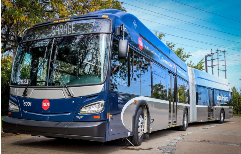
Kuva 9. Clevelandin HealthLine-linjan bussi, jossa on kolme ovea oikealle ja kaksi ovea vasemmalle. Lähde .
